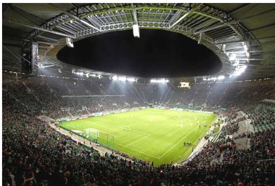
Рис. 1.44 – НСК «Олімпійський» (м. Київ) на 68 055 місць (футбол і легка атлетика). Освітлення стадіону – 608 шт. Arena Vision 2000 Вт, з яких 380 шт. – «вогняне кільце», 228 шт. – безпосередньо під кривлею
